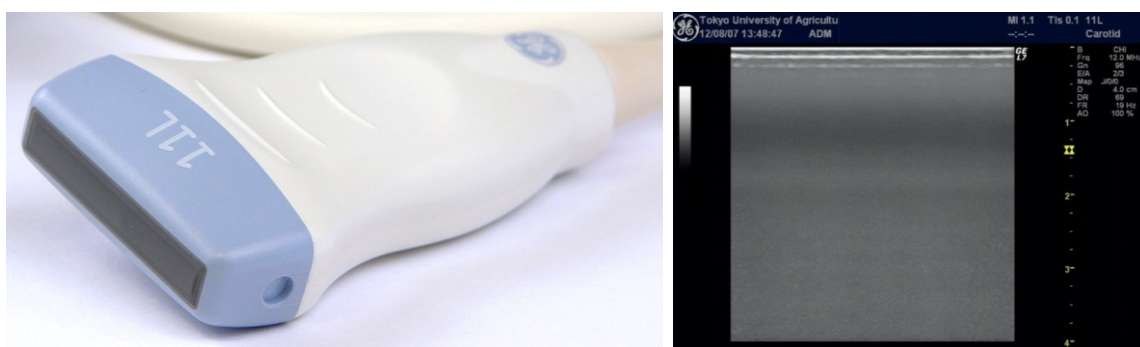
Fig.3.4 LOGIQ7 に搭載されているリニアプローブと画像の形状
