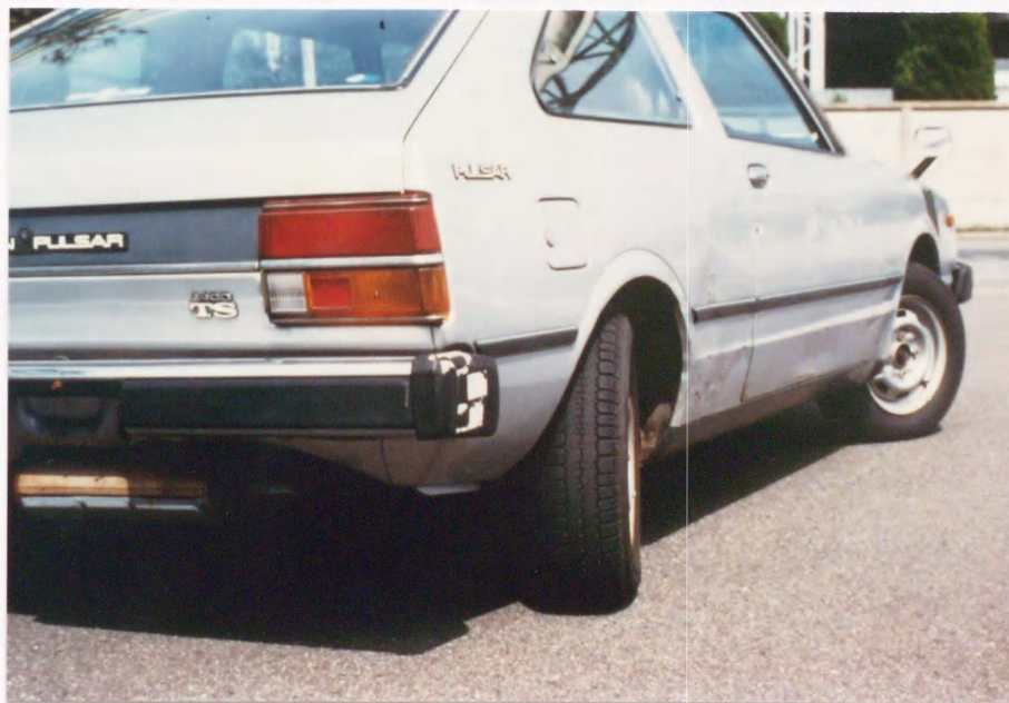
(b) 後輪を前輪と逆相に操舵した状態
