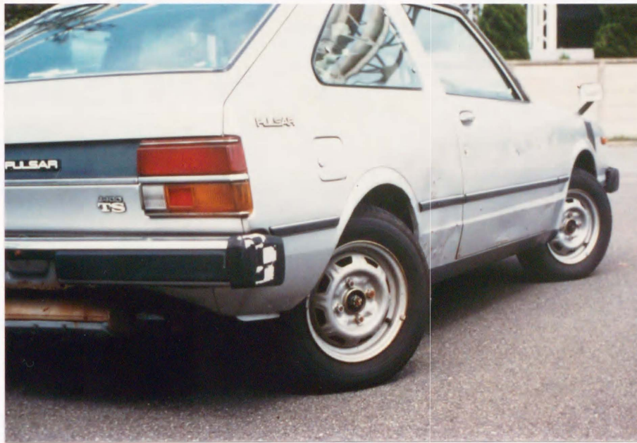
(a) 後輪を前輪と同相に操舵した状態
