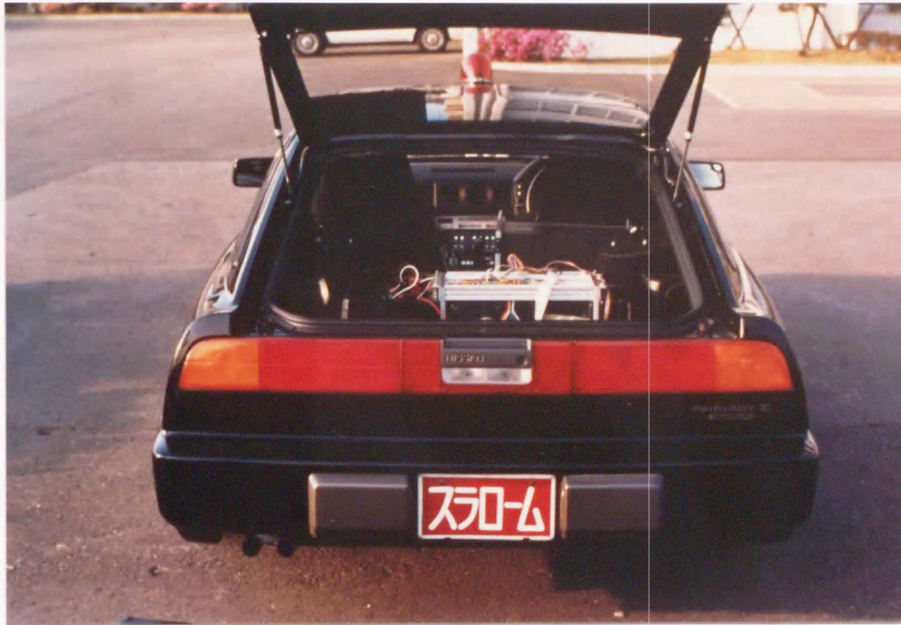
図 5 - 9 前後輪がアクティブに操舵できる実験車 (写真)
