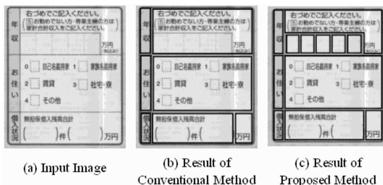
図 4-19 L字セル認識結果の例
