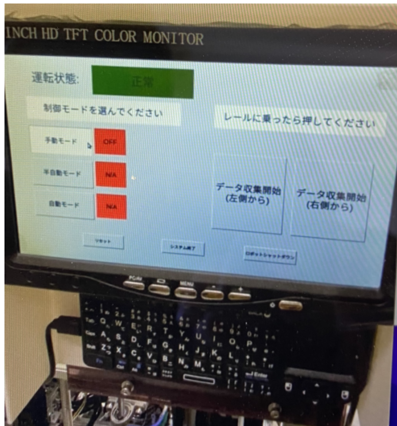
図 3.15: グラフィカルユーザインターフェイスの例. ユーザはこのインターフェイスを通してロボットに指示する. ボタンは実験に対応している.
