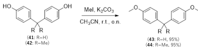
図 2.2.10 【メチレン、ジメチルメチレンリンカーのビスアニソール合成】
