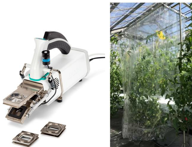
図 4 左：個葉光合成速度測定装置 (LI-6800; LI-COR, Inc) 右：群落光合成速度測定装置 (Photosynthesis Cell; Kyowa Co., LTD.)
