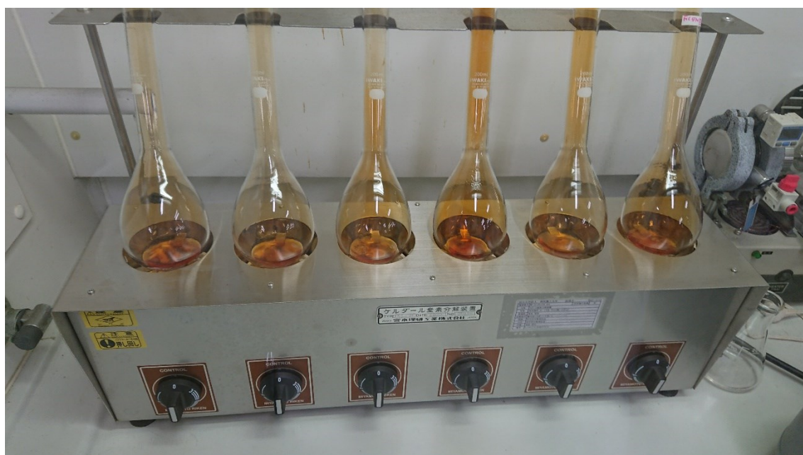
図 3-2 湿式灰化の様子(硝酸分解)
