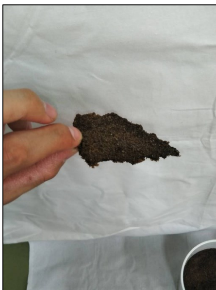
図 4-14 抽出液の散布によってできた土壌表面のクラスト
