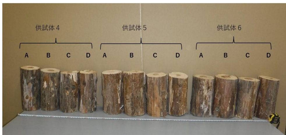
図-43 スギ供試体 4～6 を四等分して得た供試体 A, B, C, D
