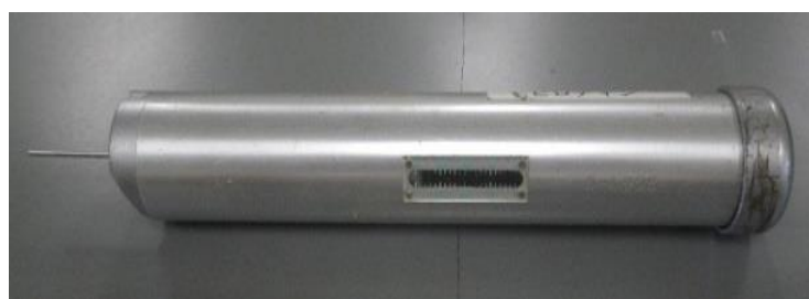
図-2 PROCEQ 製ピロディン
