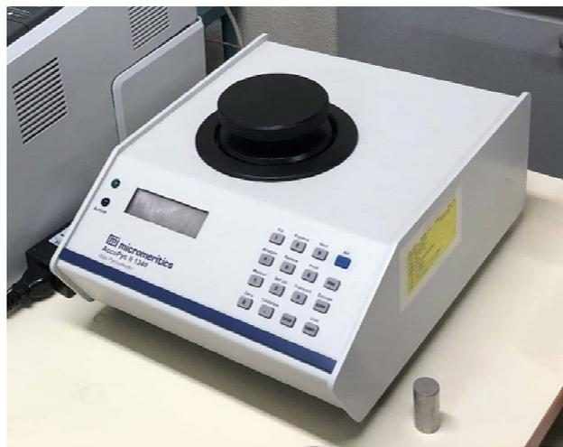
図 2-6. 真密度計 (Micromeritics, AccuPyc II 1340).
