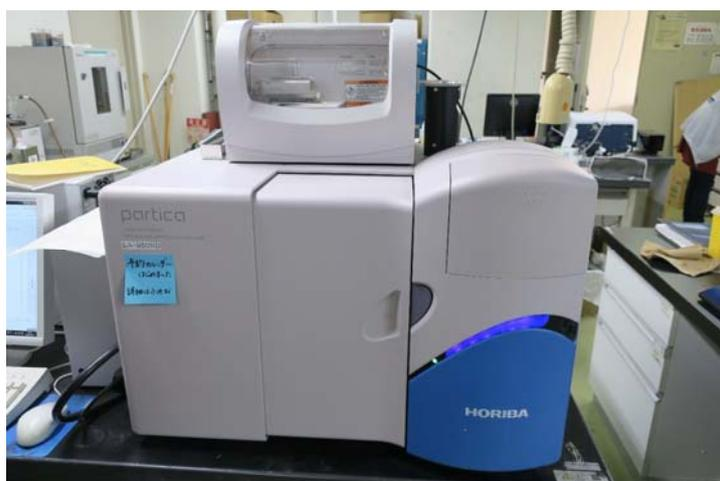
図 2-4. 粒子径分布測定装置 (Horiba, LA-950ND).
