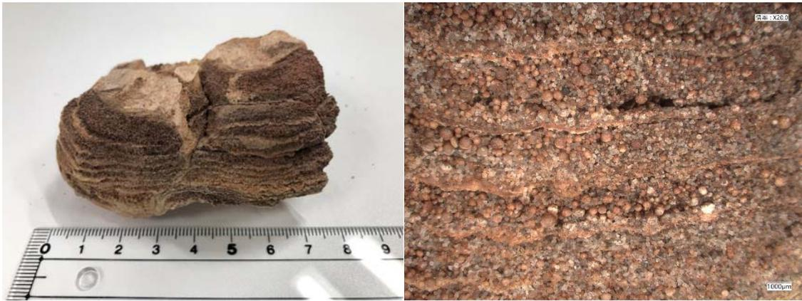
図 1- 12.下水汚泥焼却炉の内部壁面付着物の例 (筆者撮影). (左) 全体の外観写真と (右) 拡大写真.
