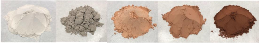
図 1-9. 異なる流動焼却炉から採取した下水汚泥焼却灰の外観例 (筆者撮影).
