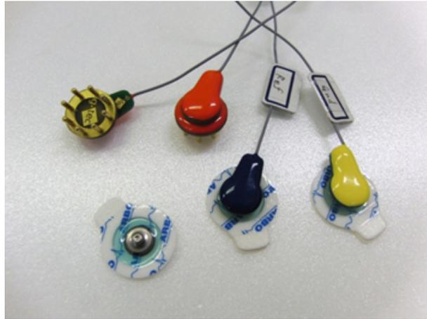
図 4.6: 脳波を計測する乾電極
