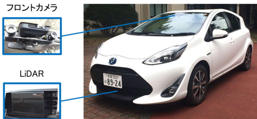
図 6.1 走行データ収集に用いた車両とセンシング装置
