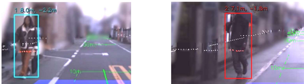
図 6.9 歩行者検知結果と LiDAR 点群情報のマッチングの様子
