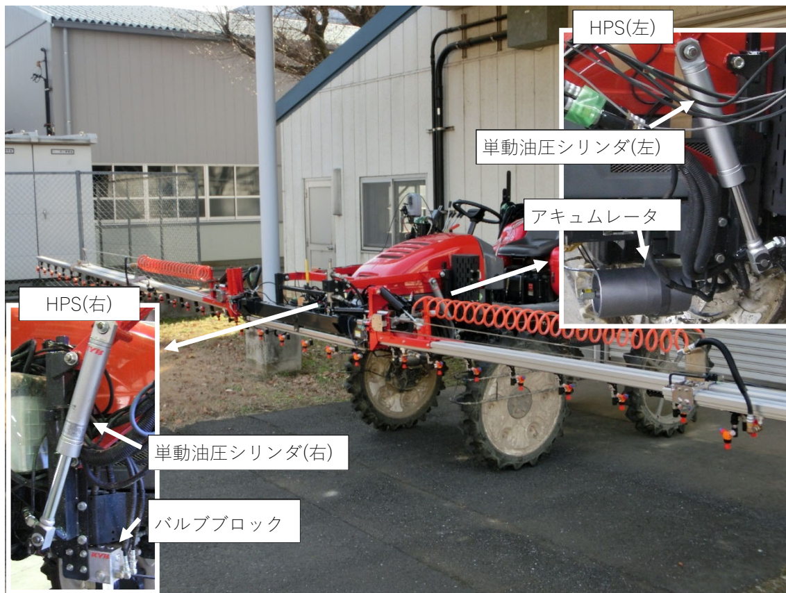
図 3-1 HPS を搭載した乗用管理機型ブームスプレーヤ
