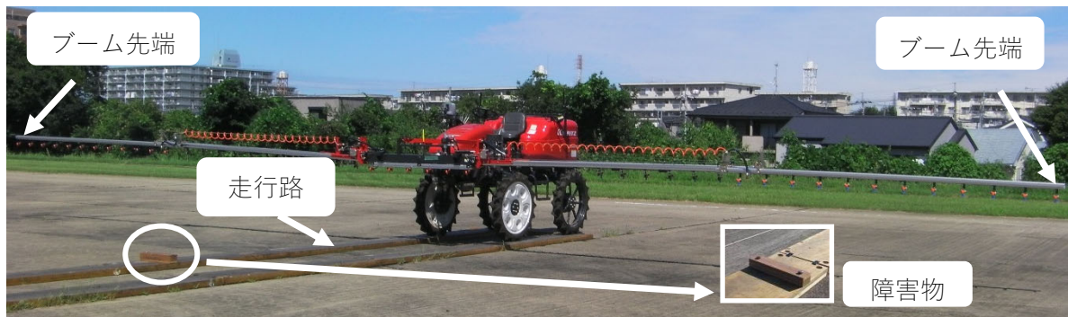
図 6-2 ブーム振動抑制効果試験の様子と障害物
