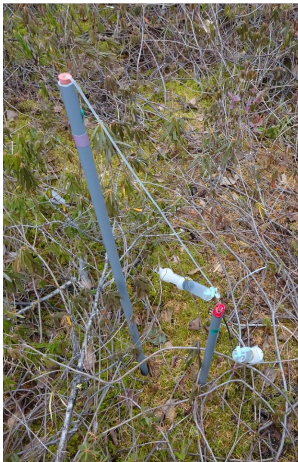
図 S3 土壌間隙水の採水の様子と塩ビ管付きポラスカップ(自作)の詳細
