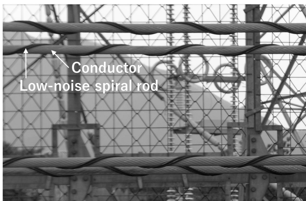
図 2.51 コロナケージ内の低騒音スパイラル線を装着した電線
