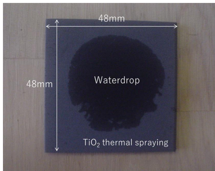
図 2.37 酸化チタン溶射表面上の水滴 (20 \mu l)
