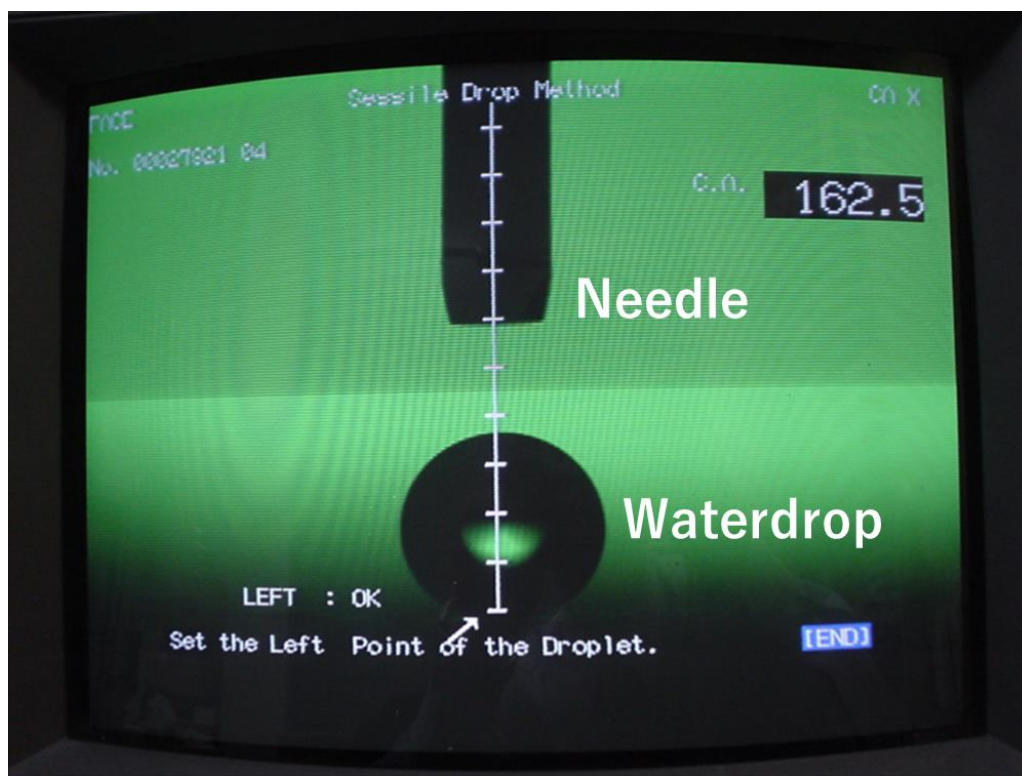
図 2.35 液滴法の接触角計による測定
