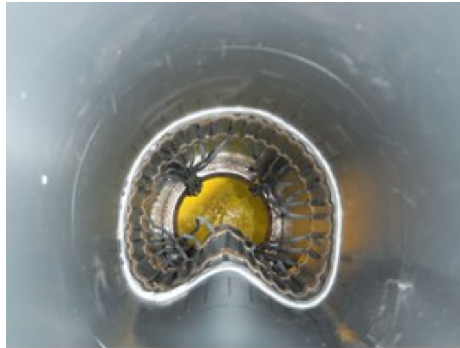
Fig. 3-28 2R 馬蹄形管における試験終了直後の管内状況 (Case3-10)
