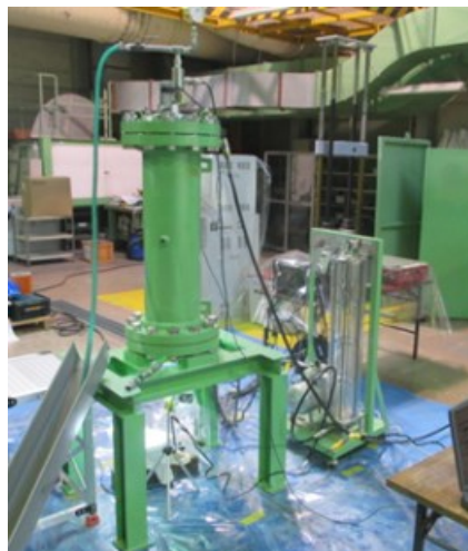
Fig. 5-2 外水圧試験装置全体図
