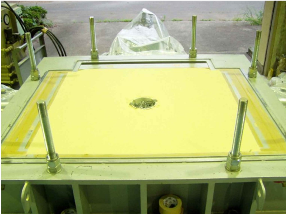
Fig. 2-9 模型土槽試験装置における地盤作製状況
