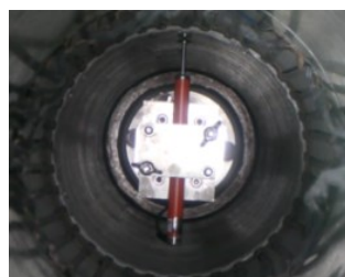
Fig. 4-6 回転式接触型変位計設置図
