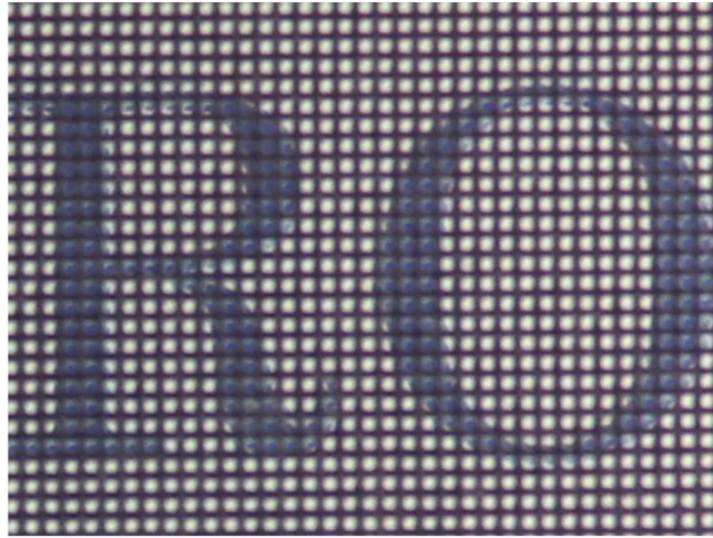
図 3.7 実験システムにおけるレンズアレイ 4 を拡大した画像（実物体までの距離：50 mm）
