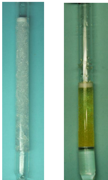
図 2-11 膨潤ゲル粒子を充填した時 (左) および吸着実験終了時 (右) の固定層の外観
