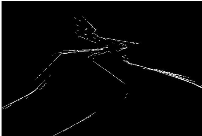
図 2.6 Hough 変換による輪郭線検出
