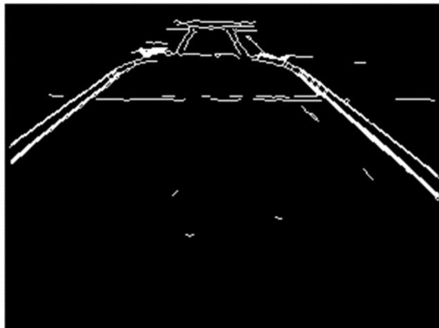
図 4.19 輪郭線検出（路面うねり）
