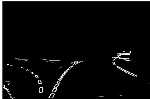
図 4.15 輪郭線検出 (分岐路)
