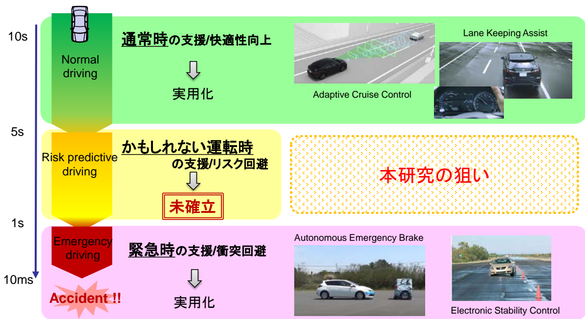
図 1.24 運転状態の階層構造と既存の運転支援技術の整理
