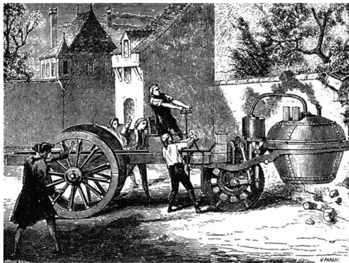
図 1.1 ニコラ・ジョセフ・キュニョーの蒸気自動車
