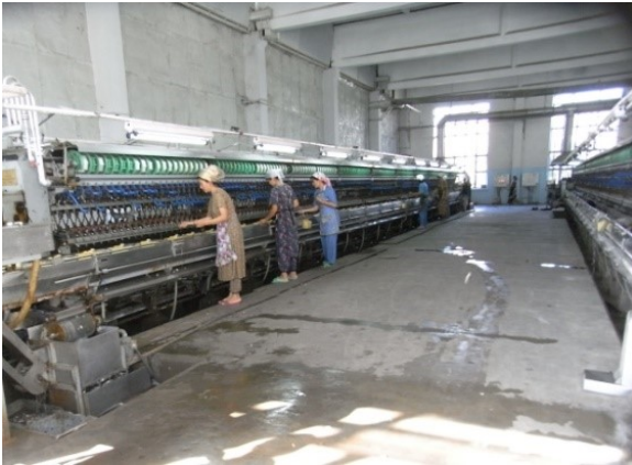
図 1-2 ウズベキスタンの自動繰糸機を使用した製糸の様子
