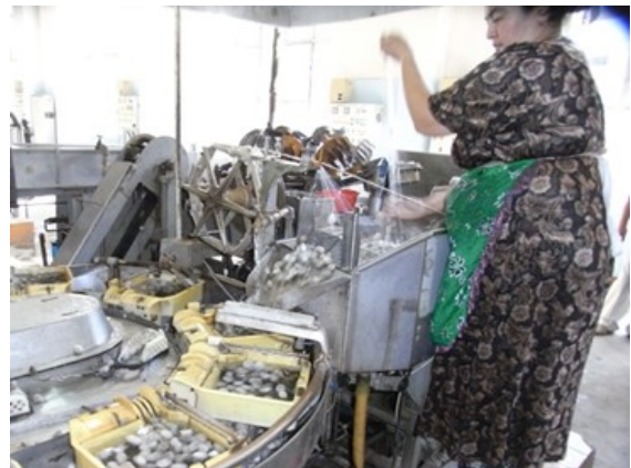
図 1-2 ウズベキスタンの自動繰糸機を使用した製糸の様子
