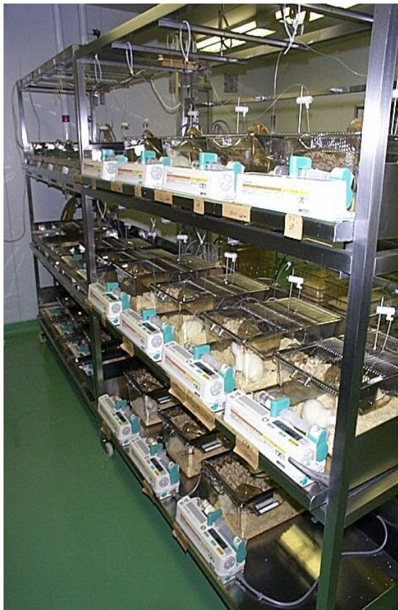
図 1. ラットフリームービングインフュージョンシステム
