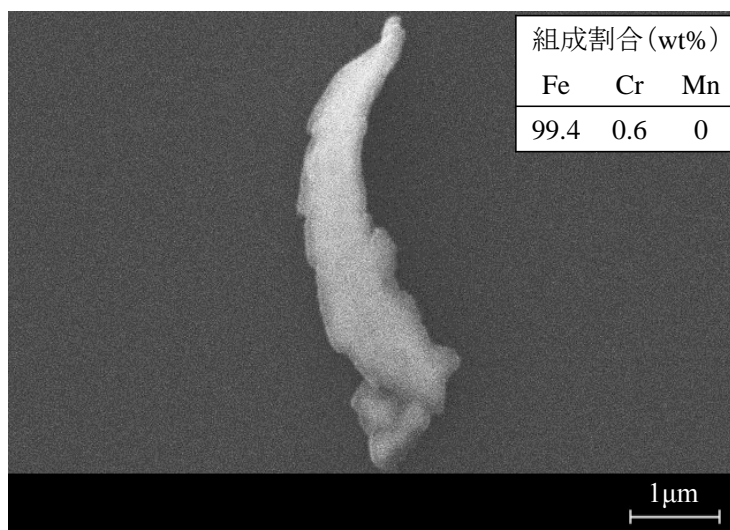
Fig. 4-6 アブレイブ摩耗試験で確認した金属摩耗粒子
