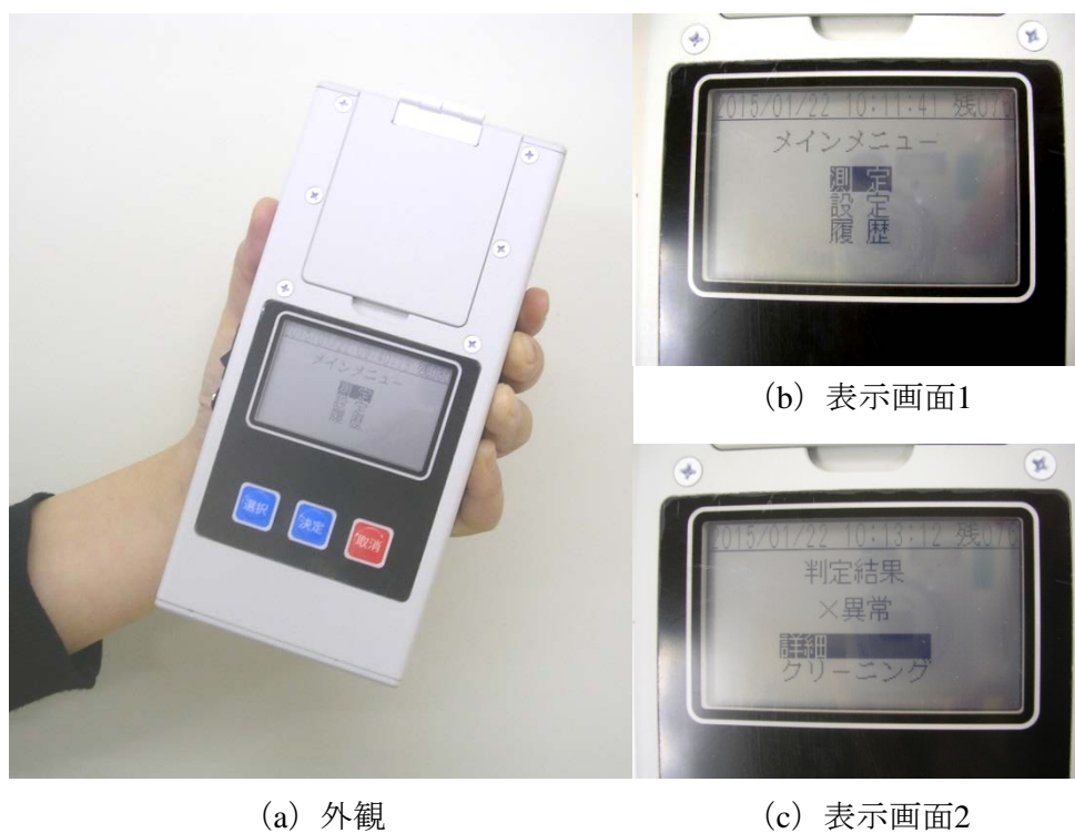
Fig. 6-3 劣化簡易測定装置と表示画面
