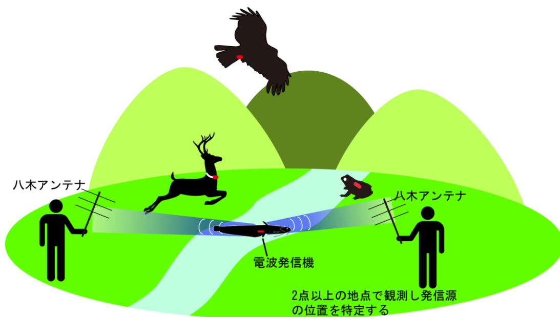
Fig. 1-3 超音波（上図）と電波テレメトリー（下図）の原理
