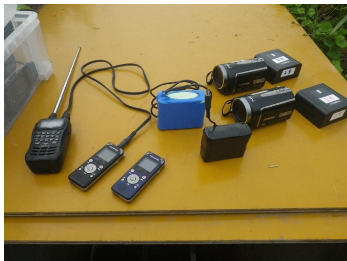
Photo 6-1 固定型レシーバーと接続された IC レコーダー
