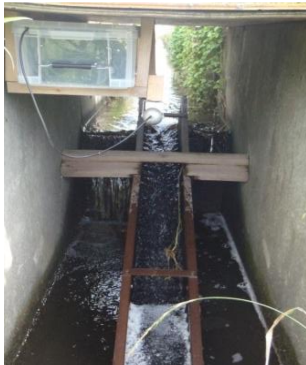
Photo 6-2 第1落差に設置した魚道および赤外線カメラ
