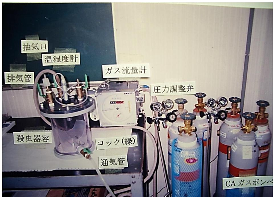
図 2-1 高濃度 CO<sub>2</sub> 殺虫試験装置
