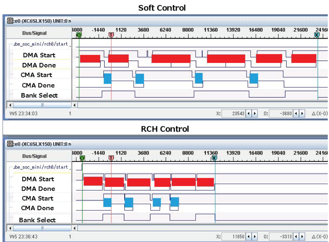
図 4.7.3 ソフトウェアによる CMA・DMAC 制御と RCH による制御の詳細
